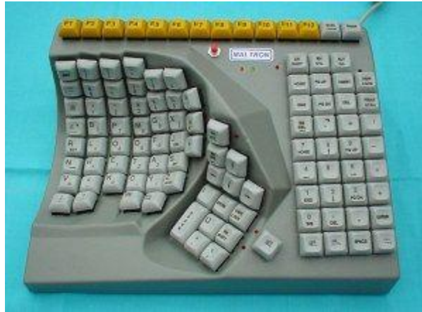
Ilustración 4. Teclado adaptado para una sola mano
